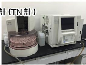
TOC 計は液体試料に含まれる有機物の総量を有機体炭素として分析する装置です。TOC は水の有機物汚染量を示す指標になっています。燃焼触媒酸化方式により、難分解性・不溶性有機物質を含んだ有機物質の分析が可能です。また、JIS の全窒素測定法にあたる熱分解法に準拠した TN 計ユニットにより、TOC と TN を同時に分析することもできます。
