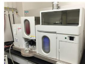
原子吸光光度計は試料中に含まれる金属元素を定量する装置です。溶液で装置に導入するため固体試料は前処理により溶液化する必要があります。フレイム原子吸光法・電気加熱原子吸光法・水素化物発生原子吸光法 (As・Se・Sb)・還元酸化原子吸光法 (Hg) が可能です。電気加熱原子吸光法は高感度で低い濃度範囲に対応でき、上水分析を行います。
