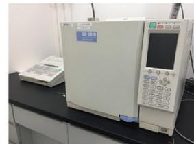
GCは気化しやすい化合物の同定・定量を行う装置です。検出器は水素炎イオン化検出器 (FID)・アルカリ熱イオン化検出器 (FTD) があります。FIDは有機化合物に対し感度が高く、逆に有機化合物以外にはほとんど感度がなため、有機化合物だけを高感度に分析したい場合に有効です。FTDはリンや窒素を含む有機化合物に高い感度を示す検出器で有機窒素系化合物・有機リン系化合物を高感度に分析できます。
